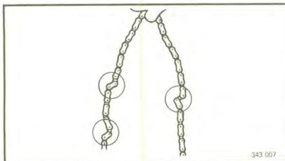
**CAM CHAIN AND CAM SPROCKET**
