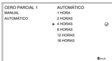
Para ajustar los contadores parcial para que se reinicien automáticamente:
