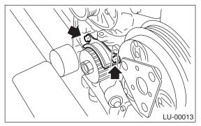
13) Remove the crank sprocket.
