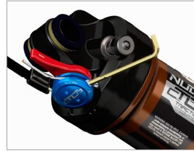
3. Tense el cable y apriete el tornillo fijador (S7) girándolo en el sentido de las agujas del reloj con una llave allen de 2mm. Par de apriete 1.6Nm.
