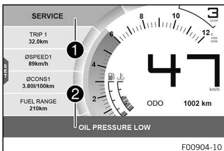
Las advertencias se muestran en el margen superior o inferior del display; en función de la relevancia se resaltan en amarillo o rojo. Las advertencias amarillas 1 indican fallos o información que requieren tomar medidas rápidamente o adaptar el estilo de conducción.
