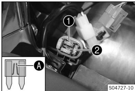
**Sustituir el fusible de la unidad hidráulica del ABS:**
