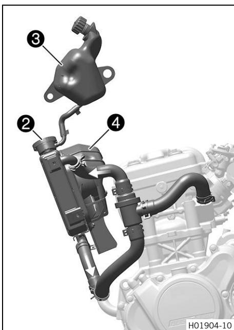
La refrigeración depende de la corriente de aire y de un ventilador del radiador 4 que se enciende a altas temperaturas.
