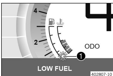
La capacidad del depósito de combustible se muestra en la zona 1 del display.
