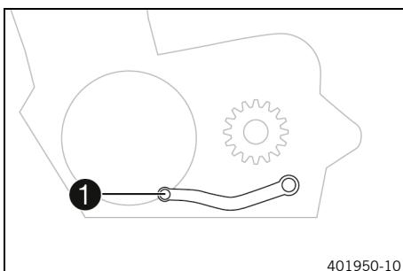
El pedal de cambio 1 está instalado a la izquierda del motor.
