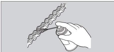
No utilice un limpiador de vapor ni de alta presión, ni cepillos de alambre, disolventes volátiles como gasolina o benceno, limpiadores abrasivos, ni limpiadores de cadenas o lubricantes NO diseñados específicamente para cadenas con juntas tóricas ya que estos elementos podrían dañar los sellos de las juntas tóricas de goma. Evite que el lubricante entre en contacto con los frenos o los neumáticos.
