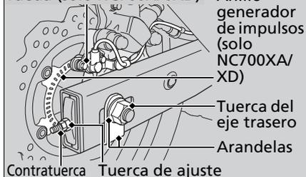
Pinchazo del neumático ► Extracción de las ruedas
