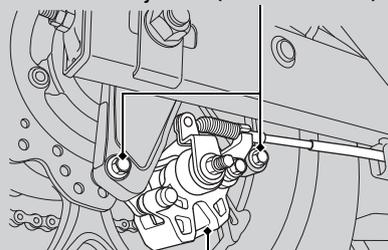
Pinza del freno de estacionamiento (solo NC700XD)
