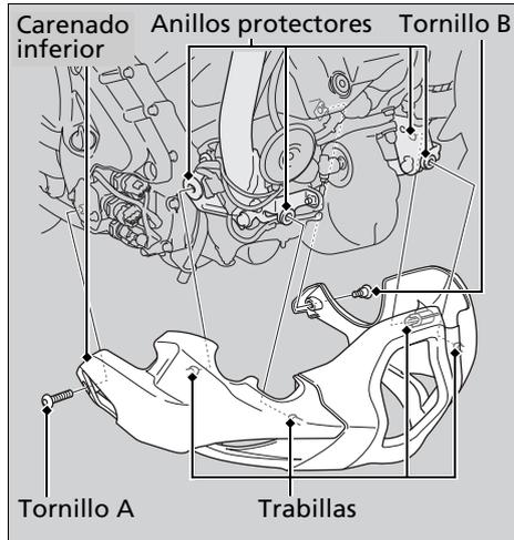
Es necesario extraer el carenado inferior para proceder al servicio del vaso de expansión del refrigerante y cambiar el filtro de aceite del motor y el filtro de aceite del embrague.
