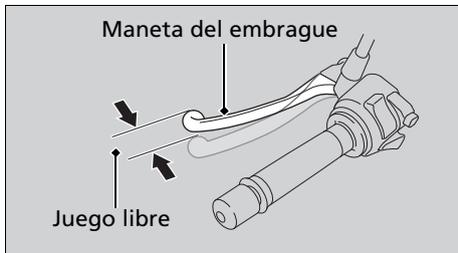
Compruebe que el cable del embrague no esté retorcido y que no muestre señales de desgaste. Si fuera necesario, haga que se lo cambien en su concesionario. Lubrique el cable del embrague con un lubricante de cables de venta en comercios especializados para evitar que se desgaste o corra prematuramente.
