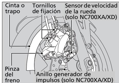
**Pinchazo del neumático ► Extracción de las ruedas**
