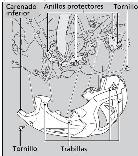
Es necesario extraer el carenado inferior para proceder al servicio del vaso de expansión del refrigerante y cambiar el filtro de aceite.
