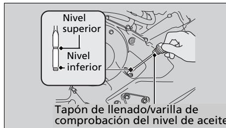
**Aceite del motor** ► Adición de aceite del motor
