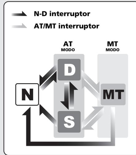
**Punto muerto (N):** El punto muerto se selecciona automáticamente al colocar el interruptor de encendido en la posición ON.
