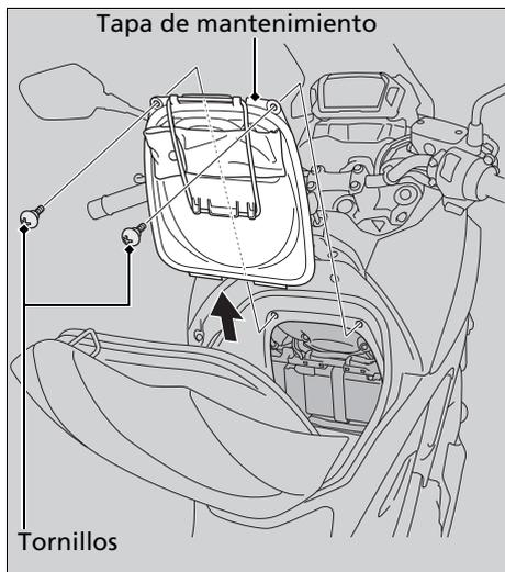
Es necesario extraer la tapa de mantenimiento para extraer la batería y proceder al servicio del fusible principal y de la caja de fusibles.
