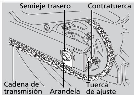
7. Extraiga el semieje trasero, el soporte de la pinza del freno y la rueda trasera y los casquillos laterales.
