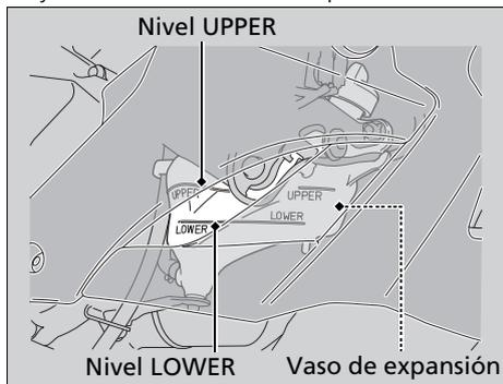
Si el nivel del refrigerante cae de forma evidente o el vaso de expansión está vacío, es probable que tenga una fuga grave. Haga inspeccionar la motocicleta en su concesionario.
