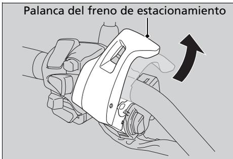
Coloque la motocicleta en una superficie firme y nivelada. Pare el motor y empuje la motocicleta mientras aprieta al máximo la palanca del freno de estacionamiento para comprobar la eficacia del freno de estacionamiento.
