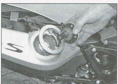
4.30 ...and remove the filler cap
